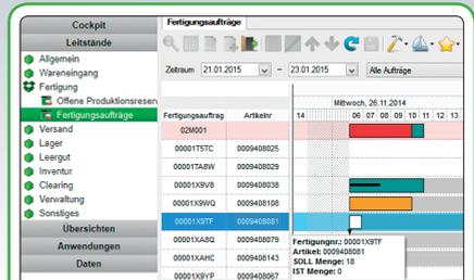
Beispiel für die Darstellung als GANTT-Übersicht aktueller Fertigungsaufträge.
